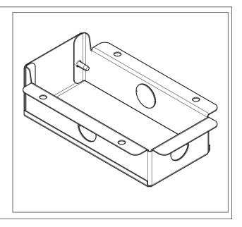
**Step 4** - Attach the conduit to the low voltage conduit entry kit enclosure with a conduit nut.
