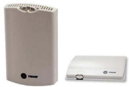
Figure 28. Split-mtd zone sensor - unit-mtd fan speed control, wall-mtd setpoint dial (OCC/UNOCC)
