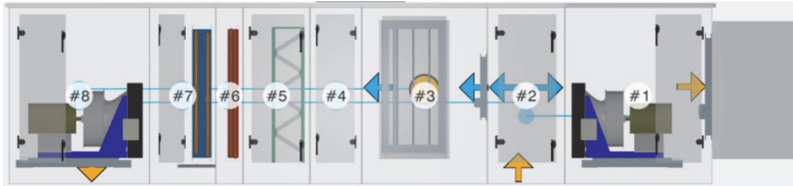
Figure 19. Plenum return fan economizer
