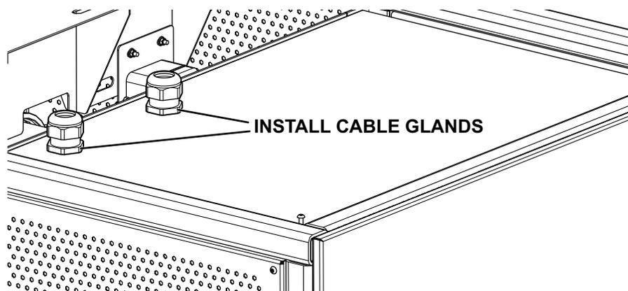
**Figure 26. Install conduit fittings**
